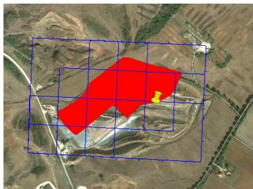
Essendo una discarica, per la determinazione della sua impronta ambientale è stato considerato come tracciante tipo una delle sostanze odorigene, l'idrogeno solforato ( $H_2S$ ), tipicamente emesse da una discarica. La quantità annua stimata di  $H_2S$  emessa dall'intera discarica è stata stimata in 1.01 t/a.
